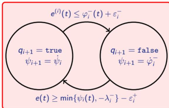
$$q_i = \text{true} \quad \Rightarrow \quad \text{Ziel: } e^{(i)} < \min\{\psi_i, -\lambda_i^-\}$$
